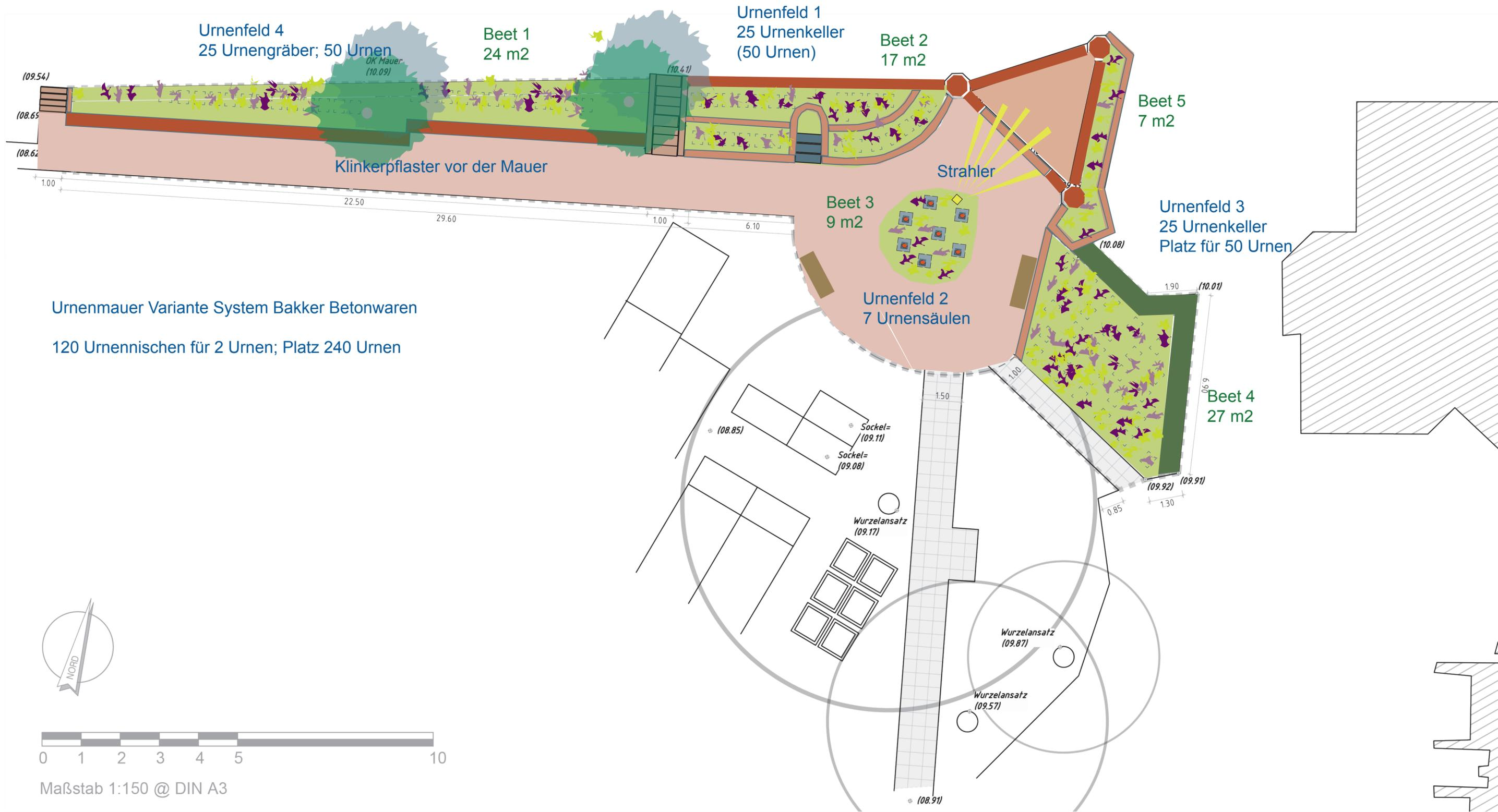
Urnenmauer Variante System Bakker Betonwaren
